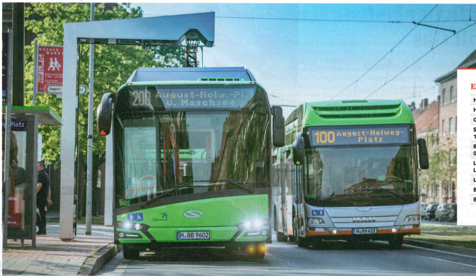
Ein Elektrobus beim Aufladen: Der Pantograf ist am Lademast angedockt
