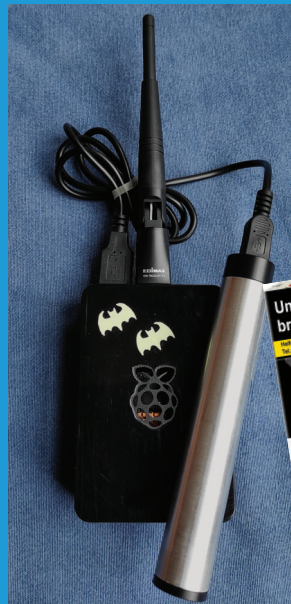
Bat Pi mit WLAN-Antenne und Dodotronic Ultramic250K, so groß, wie eine Zigarettenschachtel
