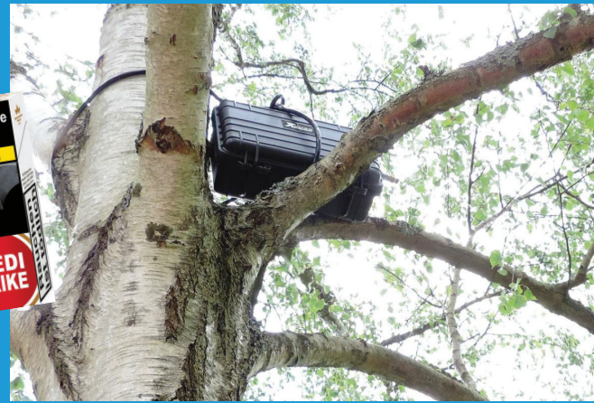
Bat Pi Horchbox mit Dodotronic Ultramic250K im Einsatz
