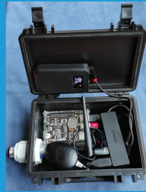
Bat Pi Horchbox mit Dodotronic Ultramic250K und Powerbank
